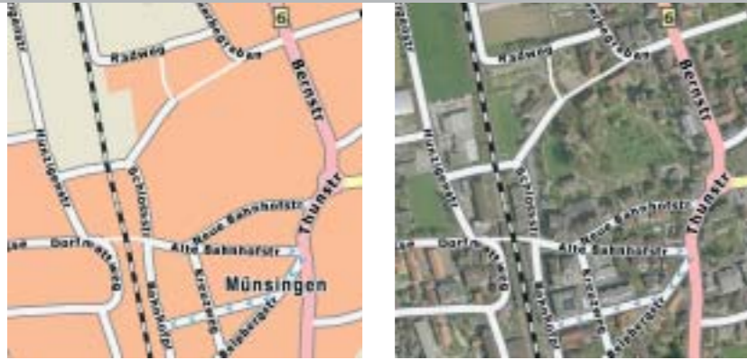
Tele Atlas MultiNet-Daten in GEOLineMap als Rasterkarte 1:5.000 (links) und auf einem Orthophoto 1:5.000 (rechts)
